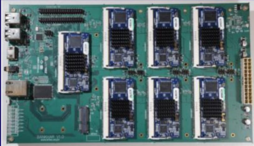
Figura 1 - Protótipo da plataforma SBC-High com processamento por múltiplos núcleos (Bankhar)
